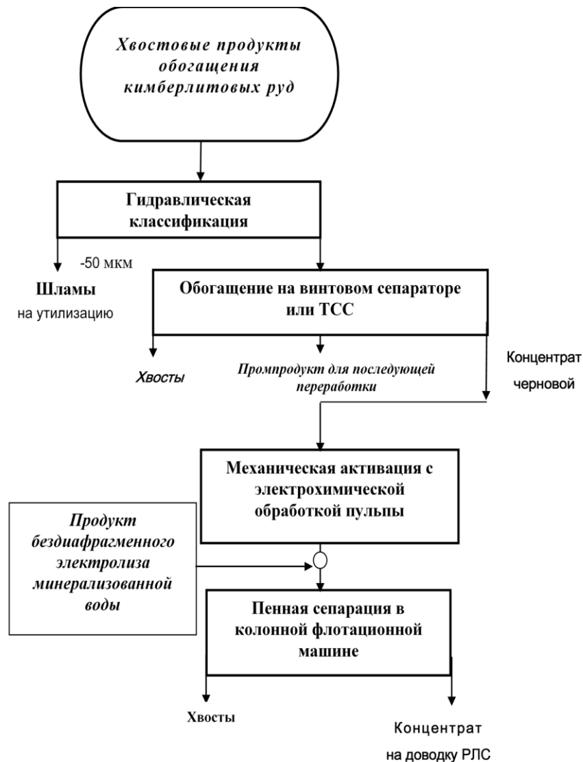
Рисунок 7.19 – Принципиальная схема переработки алмазосодержащих россыпей, текущих и лежалых хвостов переработки кимберлитовых руд
