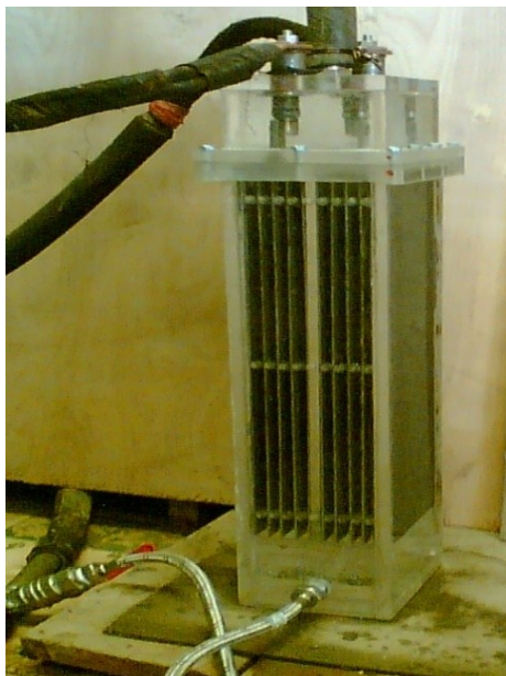
Рисунок 6.3 – Бездиафрагменный электролизер с двумя электродными блоками
