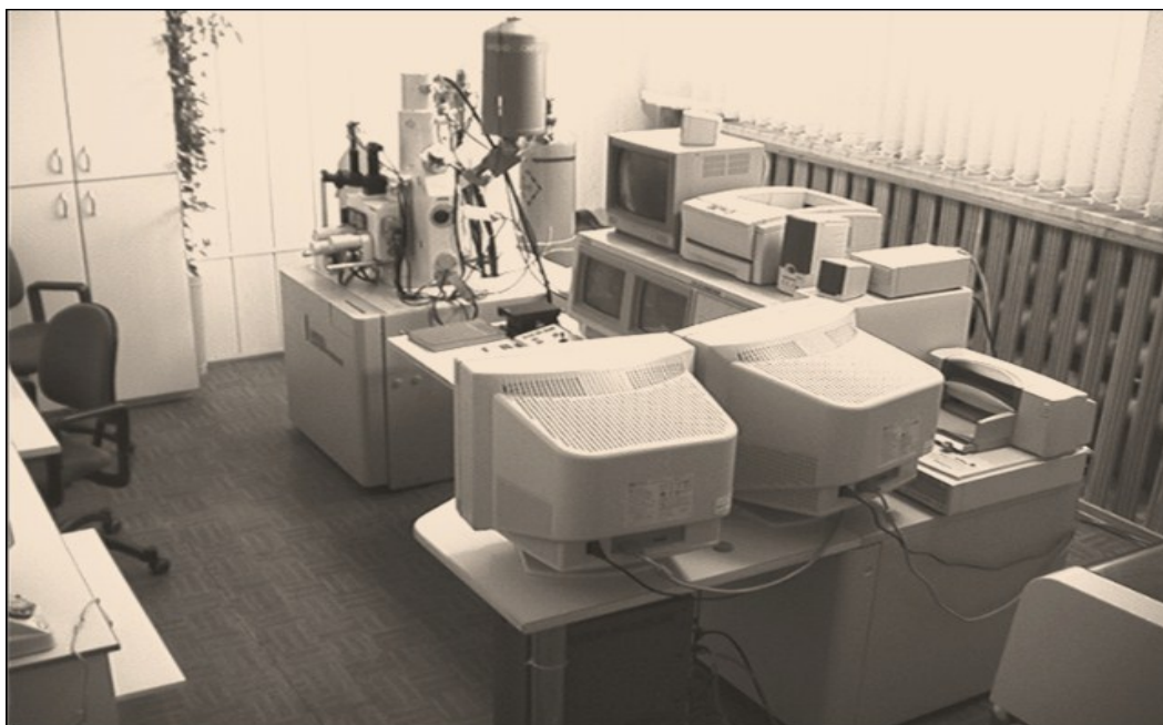
Рисунок.2.8 – Рентгеноспектральный микроанализатор JXA-8800R Superprobe производства компании Jeol (Япония) с рентгеноспектральной приставкой LINK - ISIS 300 фирмы "Oxford" (Англия)
