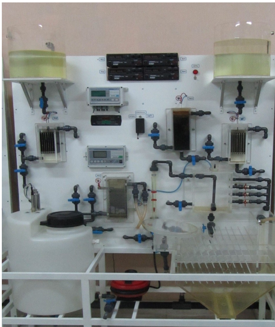
Рисунок 5.4 – Стендовая установка для проведения исследований процесса электрохимического кондиционирования водных систем, модификации и активации свойств минеральных компонентов
