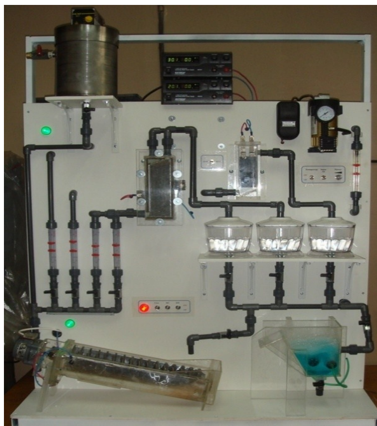
Рисунок 5.2 – Лабораторный макет для проведения исследований электрохимического кондиционирования водных систем в процессе пенной сепарации
