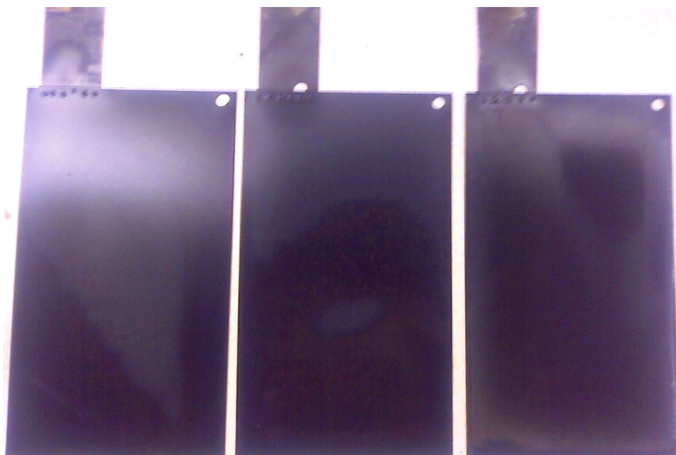
Рисунок 6.11 – Внешний вид катодов в процессе их эксплуатации с периодической переполюсовкой
